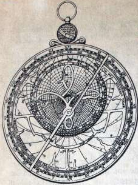
Un astrolabio de 1574. Gracias a este instrumento, los marinos podían determinar la latitud y calcular la hora, de acuerdo con la posición de los astros.
