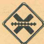
PASO A NIVEL CON FF.CC.
