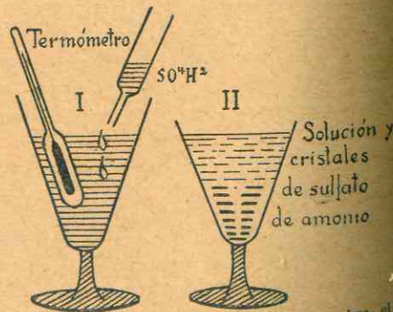
Fig. 152. - Acción del \text{SO}_4\text{H}_2 sobre el amoníaco.
