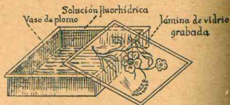
Fig. 123. - Grabado sobre vidrio por el FH gaseoso.
