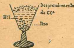
Fig. 370. — El \text{ClH} descompone el \text{CO}_3\text{Ca} , con producción de \text{CO}_2 .
