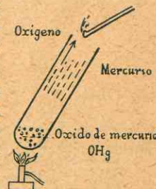
Fig. 136. - Segunda parte del experimento de Lavoisier.
