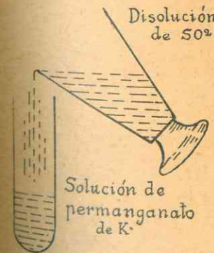
Fig. 208. - Poder reductor del anhídrido sulfuroso.
