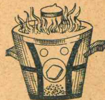
Fig. 316. — Preparación de una aleación en un crisol.
