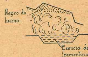
Fig. 240. — Obtención del negro de humo por combustión de la esencia de trementina.
