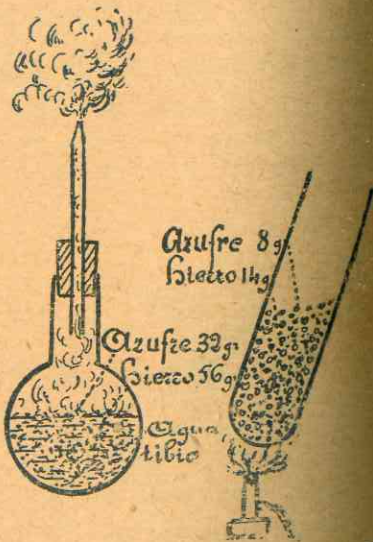
Fig. 206. - Preparación del sulfuro de hierro. Volcán de Lémery.
