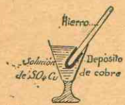
Fig. 349. - Acción del hierro sobre el \text{SO}_4\text{Cu} .
