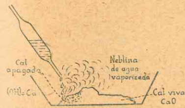
Fig. 364. - Preparación de la cal apagada.
