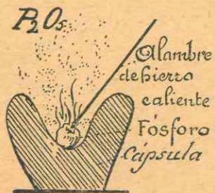
Fig. 212. - Combustión del fósforo en el aire.
