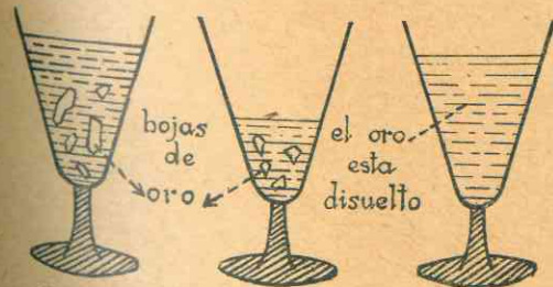
Fig. 172. - El oro insoluble en los ácidos: \text{ClH} \text{NO}_3\text{H} , se disuelve en su mezcla (agua regia).
