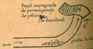
Fig. 188. — Obtención del SO 2 por tostación de las piritas.
