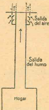
Fig. 163 - Ventilación por chimenea de aspiración.
