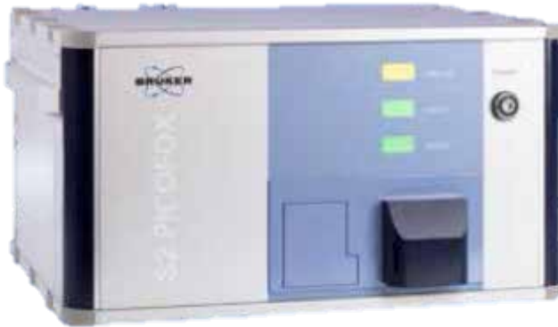
Figura 17. Equipo de fluorescencia de rayos X S2 PICOFOX
