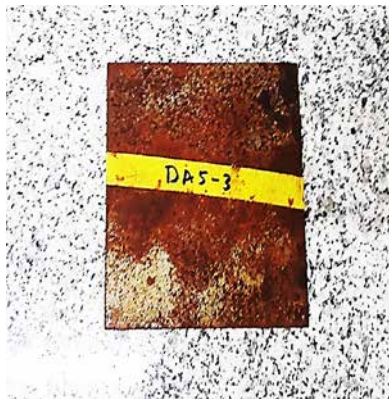
Figura 10. Probetas oxidadas de acero ASTM A572
