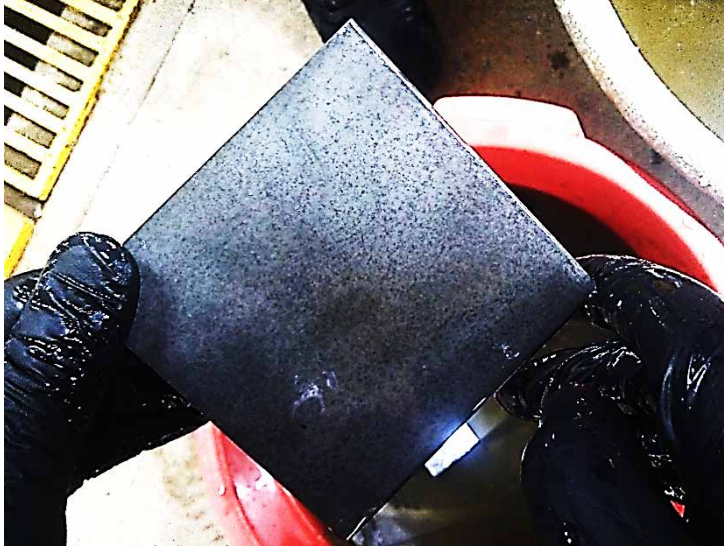
Figura 11. Probeta decapada de acero ASTM A572
