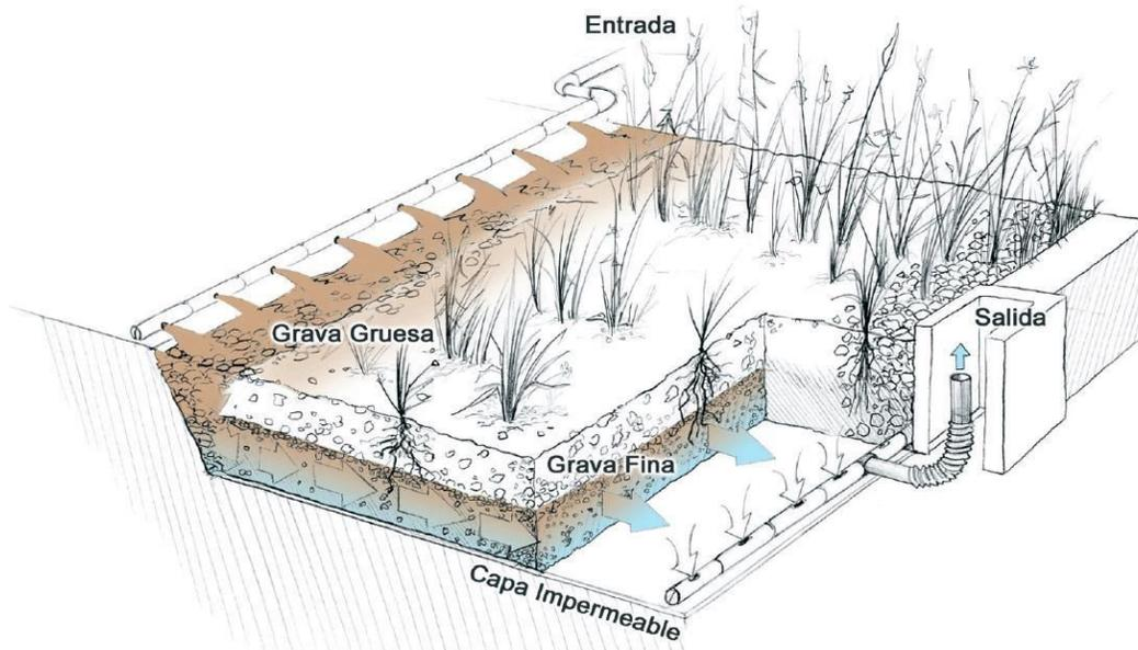
**Figura 3.** Humedal Construido de Flujo Subsuperficial Horizontal. Tomado de Delgadillo, 2010. [18]
