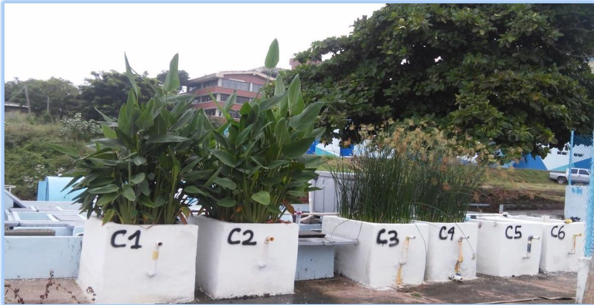
**Figura 6.** Fotografía del Sistema Experimental de Humedales Construidos de Flujo Sub Superficial Horizontal (HC FSSH)
