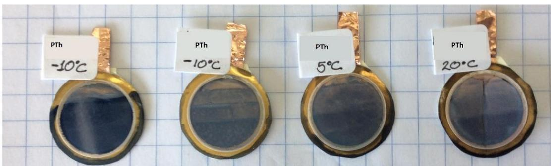
**Figura 35.** Superficie de los electrodos observada por la variación en el tiempo de electrosíntesis.
