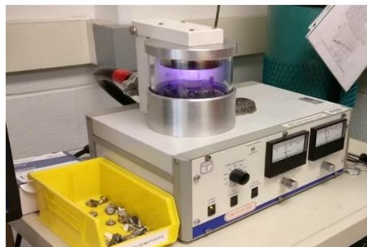
**Figura 15.** *Sputtering* de Oro, a la izquierda el esquema del proceso, a la derecha el equipo utilizado[73]
