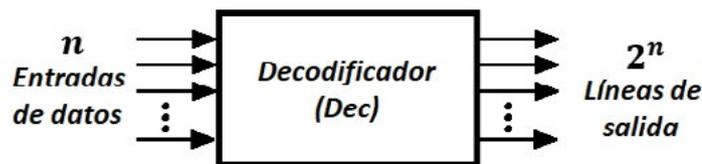
Figura 11.1. Diagrama de bloques de un decodificador
