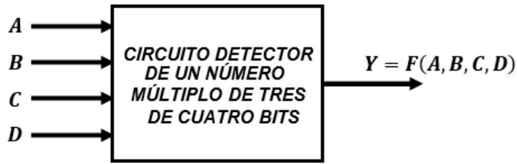
Figura 10.2. Diagrama en bloque de un circuito combinacional
