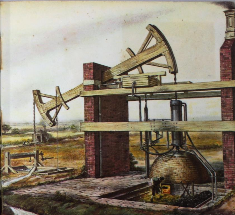
En la campiña inglesa, la máquina de vapor de Newcomen. La gruesa viga basculante está unida al pistón que penetra en el cilindro. Este movimiento lleva arriba el pistón de la bomba de la mina. Cuando se introduce el vapor por debajo del pistón, el balancín volvía a la posición indicada en el dibujo.
