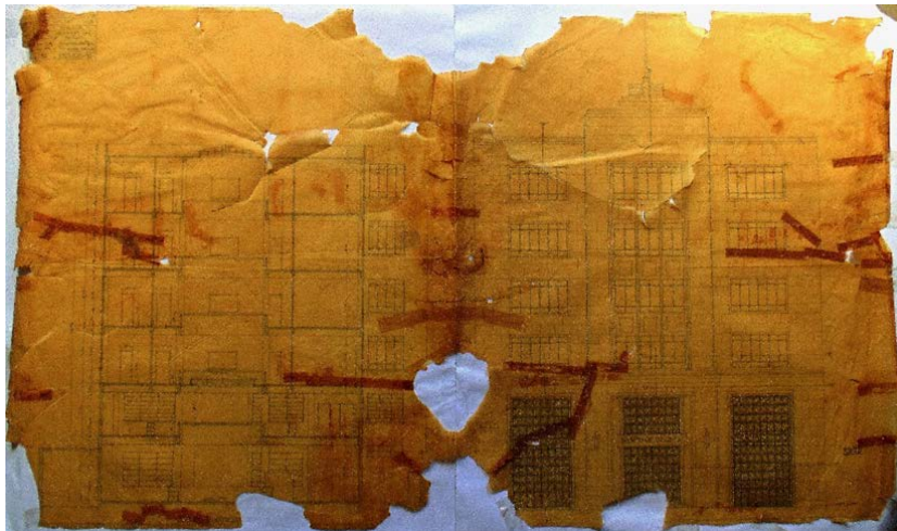
Figura 4. Ejemplo de un plano en mal estado
