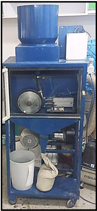
Figura 20. Máquina para ensayos de desgaste abrasivo (parámetros bajo la norma ASTM G-65 -17).
