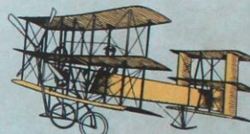
El triplano Avro era estabilizado por sus tres alas y su cola de cometa.
