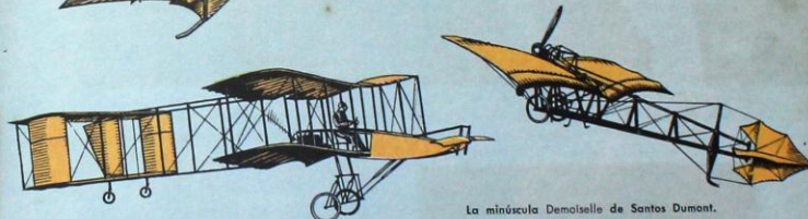
El biplano de Henry Farman tenía una cola copiada de la cometa en forma de caja de Hargrave.
