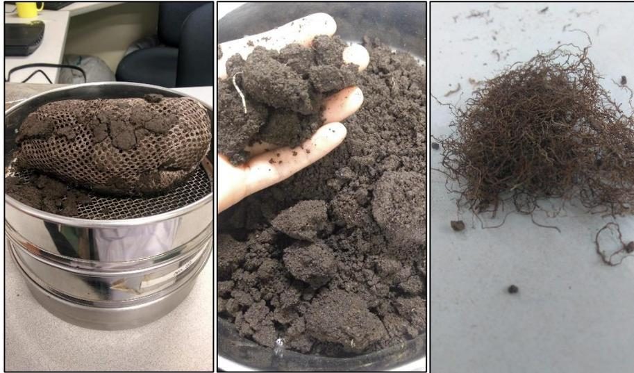
**Figura 5.** Procesamiento de raíces, de izquierda a derecha núcleo de crecimiento intacto, y separación de las raíces del suelo con tres tamices.
