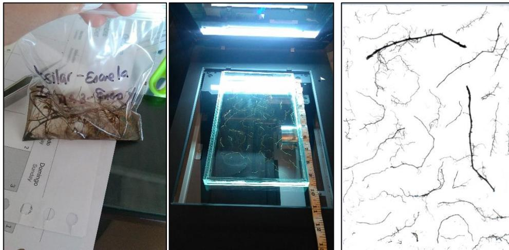
**Figura 6.** Digitalización de raíces, en la primera imagen se muestra la rehidratación, posteriormente el método de escaneo y la imagen resultante.
