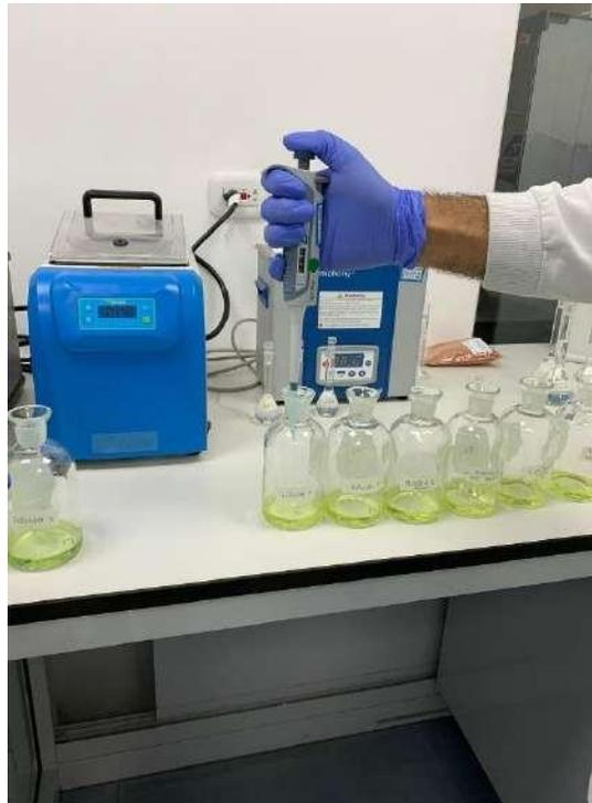
*Adición de disolución de carbonato de sodio*
