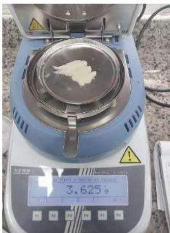
*Secado y resultado de la determinación de humedad*
